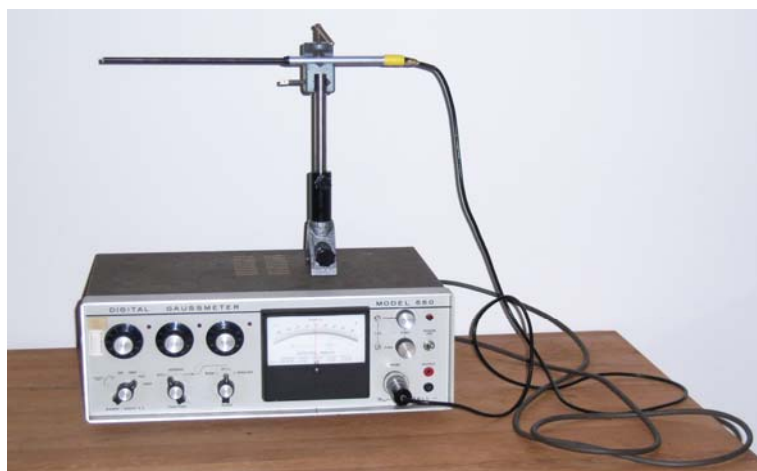
Abbildung 7.1 Hall-Sonde: Diese Hall-Sonde wird bei der Versuchsdurchführung benutzt, um das Magnetfeld zwischen den beiden Polschuhen zu vermessen.
